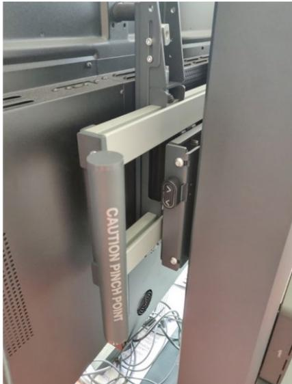
Sobald eine Stromzufuhr vorhanden ist, lässt sich das Gerät in der Höhe verstellen. Dazu befindet sich auf der rechten Seite des Geräts auf der Rückseite ein Schalter.
