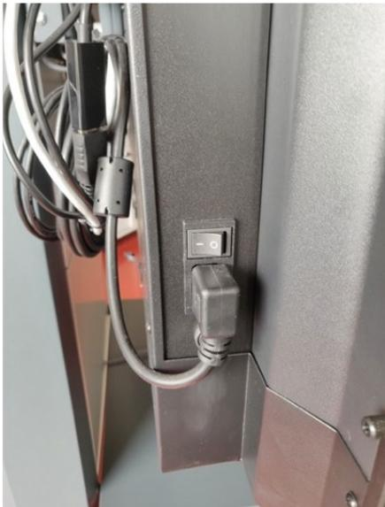
Zum Anschalten befindet sich auf der linken Seite ein Schalter, der zwischen O (Aus) und I (An) unterscheidet. Dieser ist meist an, sollte das Gerät keinen Strom haben, stellen Sie sicher, dass er an ist.
